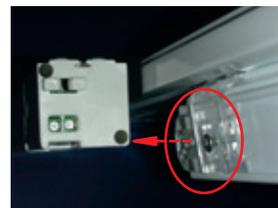
Auf das Ende des Zugwagens einen Mitnehmer aufstecken, befestigen und alles, was in Richtung Motor übersteht mit einer scharfen Zange entfernen, damit sich der Mitnehmer nicht am Motor verhaken kann.
