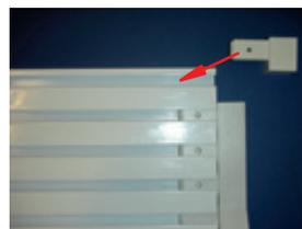
Beide Endkappen mit einem Deckel verschließen und die Deckel mit den beiliegenden Schrauben sichern. Des Weiteren mit den beiliegenden Schrauben auch die Endkappen in der Schiene befestigen. Bei fünf-flüchtigen Anlagen muss noch das Adapterstück eingesetzt werden, um die Endkappe an die Schienenbreite anzupassen.
