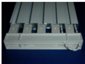
Die Antriebskette durch die ersten zwei Löcher in der Endkappe NS (nicht Antriebseite) sowie durch die Schienenkanäle 1 und 2 ziehen. Danach die Endkappe auf die Schiene stecken.
