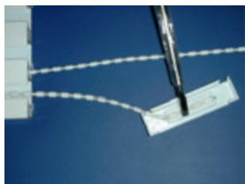
Wie im Bild gezeigt, einen Kettenverbinder am Kettende in Kanal 1 befestigen.
