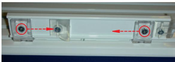
Um die Kette zu spannen, muss man nur die beiden Aufhängungen des Zugwagens gleichmäßig zusammenschieben und wieder befestigen. Dieses Spannen der Kette verändert die Zugwagenposition nicht. Endlagen werden durch dieses Nachspannen nicht beeinflusst. Die Kettenspannung muss ein weiteres Mal überprüft werden, sobald die Behänge am System befestigt sind.
